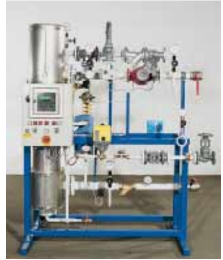
indirekter Anschluß an Dampf mit einem Heizkreis
